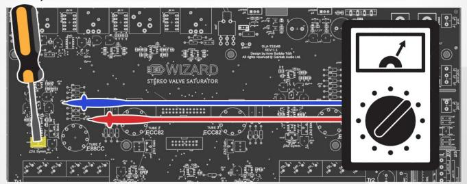
NEXT, REPEAT THE **MEASUREMENT** BETWEEN **AGND** AND **TP34**. IF NECESSARY, READJUST THE CH1 BIAS TRIMMER TO ACHIEVE **440mV** AGAIN.
