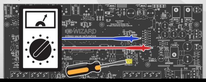
NEXT, REPEAT THE *MEASUREMENT* BETWEEN **AGND** AND **TP25**. IF NECESSARY, READJUST THE CH1 BIAS TRIMMER TO ACHIEVE **440mV** AGAIN.
