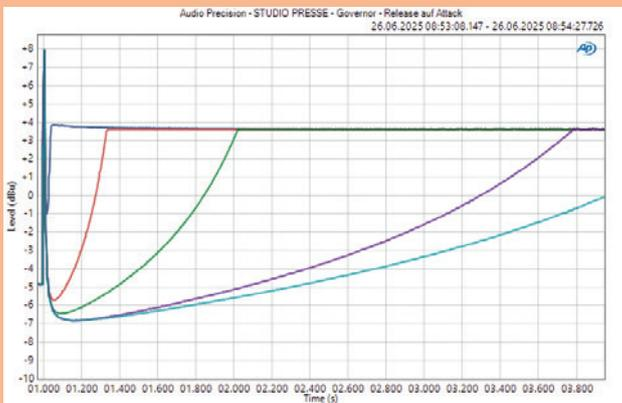
Diagramm 9: Attack-Phase - verschiedene Release-Werte
